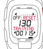
Az **OFF** nyomógomb lenyomásával visszatér a nyugalmi üzemmódba.
